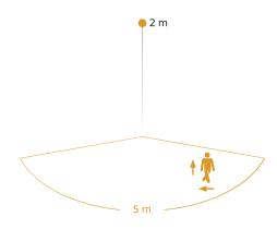
Possibile altezza di montaggio: 1,80 m - 2,50 m Arancione: direzione di movimento radiale
